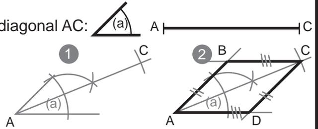
Construcción de un rombo conocidas las diagonales AC y BD:
