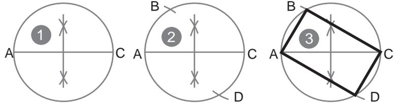
Construcción de un rectángulo conocida la suma de dos lados AE y la diagonal AC:
