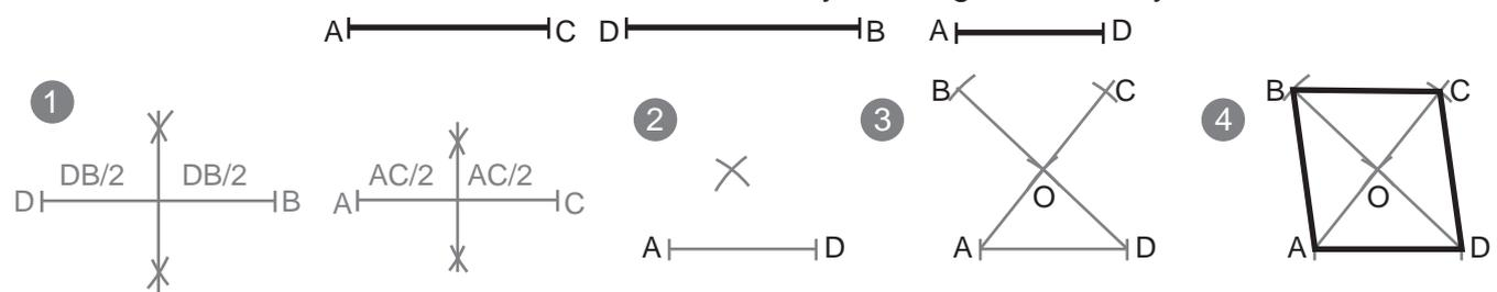
SABEMOSQUE EN CUALQUIER PARALELOGRAMO LAS DIAGONALES SE CORTAN EN SUS PUNTOS MEDIOS
