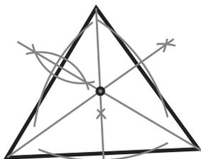
**ALTURA:** La altura en un triángulo (y en cualquier polígono) es la recta que parte de un vértice perpendicular al lado opuesto
