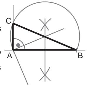
OTRO MÉTODO: Podemos sustituir los pasos 2º y 3º por el trazado del ARCO CAPAZ del ángulo dado sobre el segmento AB.
