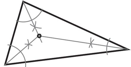
**BARICENTRO:** Intersección de las medianas, centro de gravedad del triángulo
