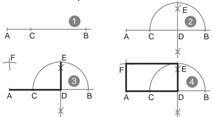
Construcción de un rectángulo dados el lado AB y la suma del otro lado y la diagonal ,AE:
