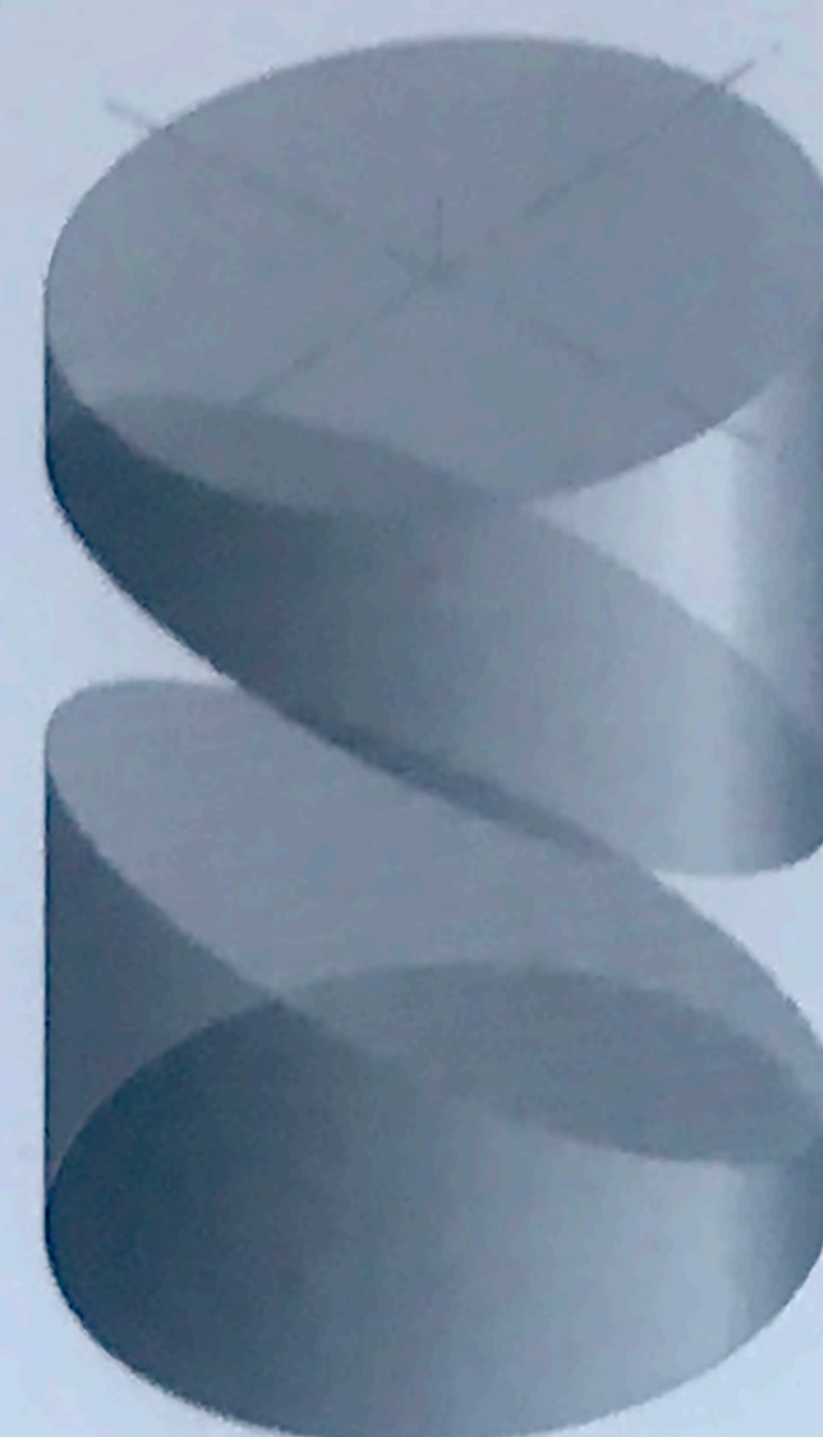
ELIPSE Sección oblicua al eje del cilindro.
