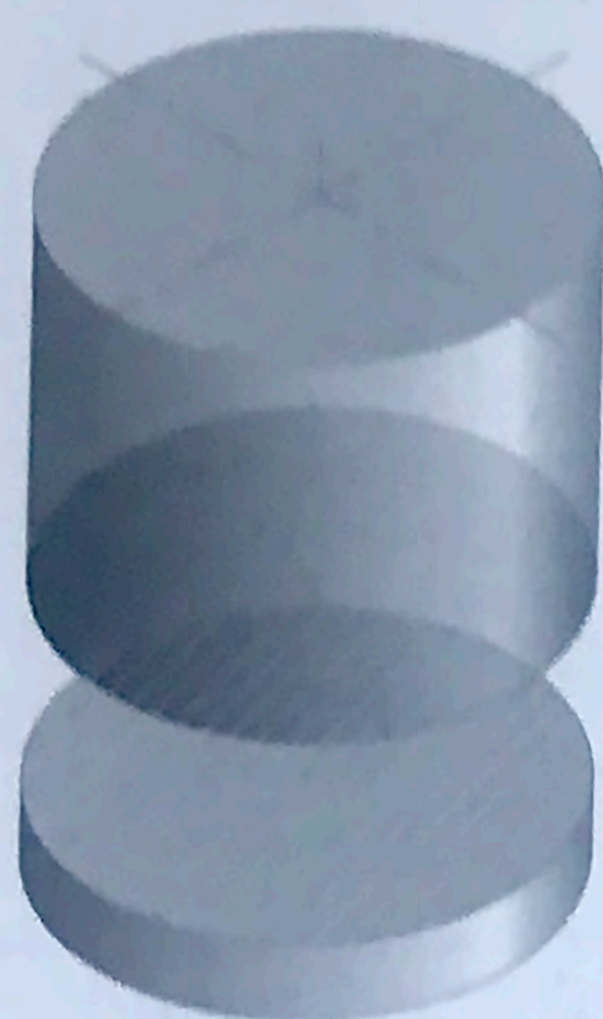
CÍRCULO Sección perpendicular al eje del cilindro.
