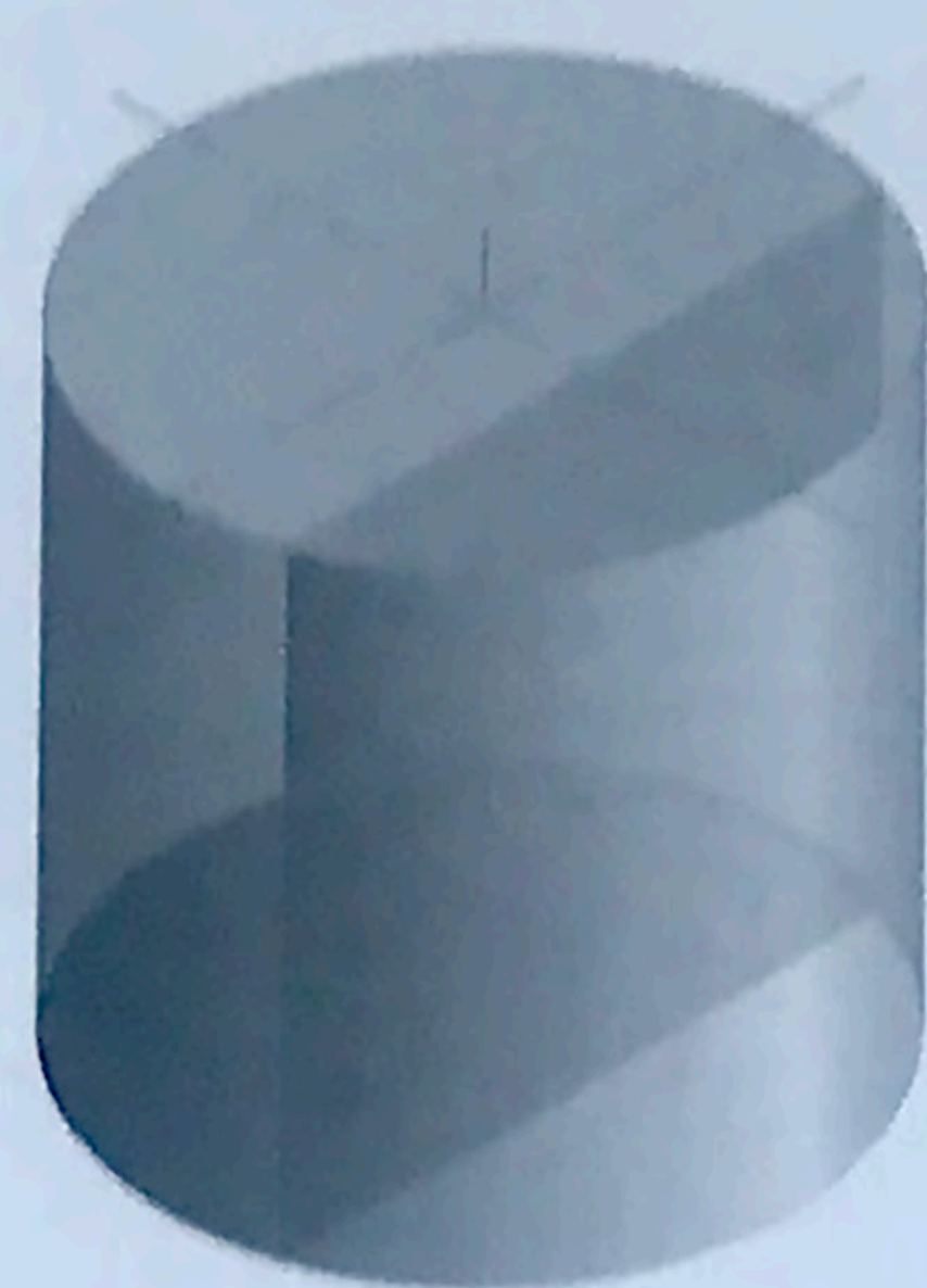
RECTÁNGULO Sección paralela al eje del cilindro.
